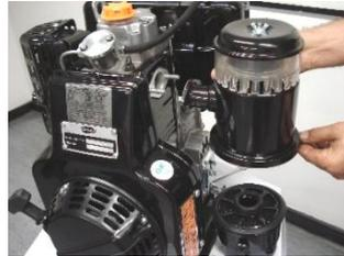
Hava filtresi üst parçasını motora takın.
