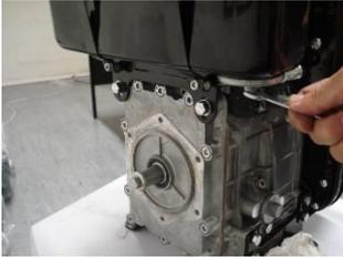
Yakıt deposunun altına uygun bir kap koyun ve filtre tablası tespit civatasını gevşetin. Place a suitable tray under the fuel tank and loosen the filter cover fixing bolt. Yakıtın boşalmasını bekleyin, tespit civatasını tam sökün. Filtre tasını çıkartın. Filtre elemanını ayırın. Placer un récipient sous le réservoir combustible et dévisser le boulon de fixation du couvercle filtre.
