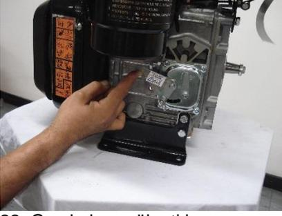
22. Gaz kolunu rölanti konumuna getirin, bir süre motoru rölantide çalıştırarak soğumasını bekleyin.
