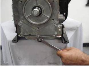
Motorun altına uygun bir kap yerleştirin. Yağ boşaltma tapasını sökün.
