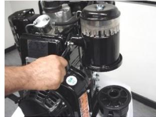
Hava filtresi üst parçasını motora bağlayan tespit somunlarını sıkın.
