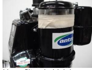
Hava filtresi girişini yapışkan bant ile kapatın. Close the intake opening with a sticky band. Fermer l'ouverture de l'admission d'air avec de la bande collante.
