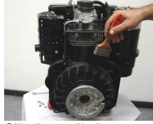
Silindir ve silindir kafasındaki soğutma kanatçıklarını gazyağına batırılmış fırça ile temizleyin.
