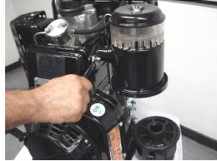
Hava filtresi üst parçasını motora bağlayan tespit somunlarını sökün.
