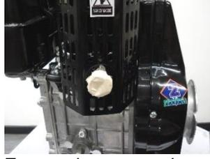
Egzoz çıkışı yapışkan band ile kapatın. Close the exhaust opening with a sticky band. Fermer l'ouverture d'échappement avec de la bande collante.
