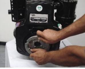
Krank milini saat ibreleri yönünde döndürerek motoru kompresyon durumuna getirin. Böylelikle her iki supap da kapalı olacaktır. Turn the engine crankshaft clockwise to bring it to the top dead center of the compression stroke. This way, both valves will be closed. Tourner le vilebrequin dans le sens horaire au point mort haut de la compression. Dans cette position les soupapes seront fermées.
