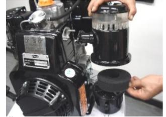
Üst parça ve sünger elemanı gazyağı ile temizleyin.
