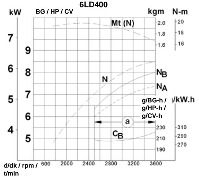
Verilen güçler alıştırma dönemini tamamlamış standart motorlar içindir. Güçler her 100 m irtifa artışı için %1, 20°C üzerindeki her 5° sıcaklık artışı için %2 azalır.
