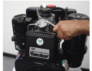
Enjektör tespit flanşını takın.Reassemble injector fixing flange.
