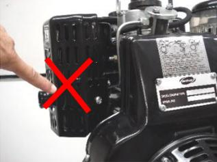
Motor çalışırken veya sıcakken sıcak yüzeylere dokunmayın.
