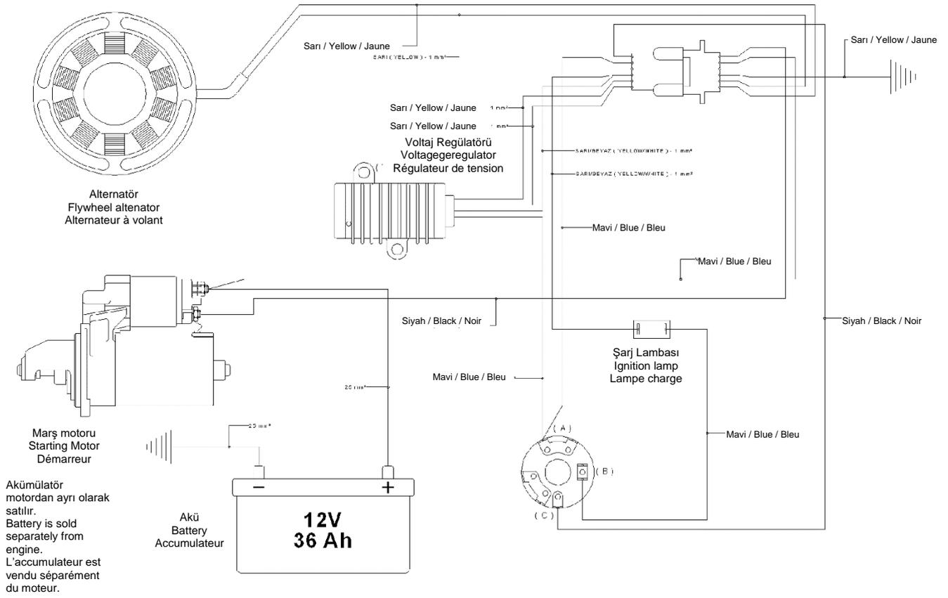
**Elektrik devre şeması [Aydınlatmalı tip] (Volan içi alternatör, voltaj regülatörü) / Electric wiring diagram [Lighting types] (Flywheel alternator, voltage regulator) / Schéma du circuit électrique [Types avec éclairage] (Alternateur à volant, régulateur de tension)**
