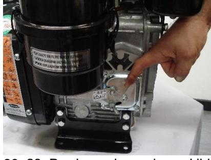
23. Durdurma levyesine şekilde gösterildiği yönde basın ve motor duruncaya kadar levreyi bu konumda tutun.
