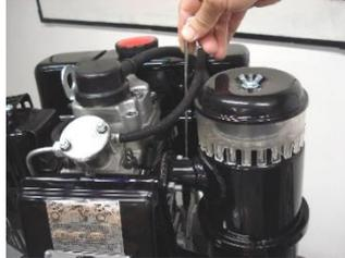
Motor çalışırken yağ seviye çubuğunu çıkarmayın.
