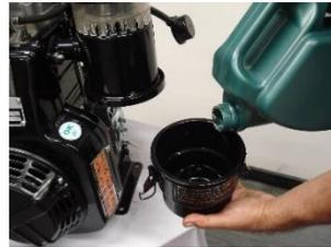
6. Kabı işaretlenmiş seviyeye kadar temiz motor yağı ile doldurun.
