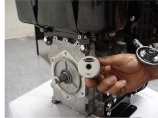
Yeni filtre elemanını contaları ile birlikte yerine takın. Install new filter cartridge with new gaskets. Monter la nouvelle cartouche avec les nouveaux joints.
