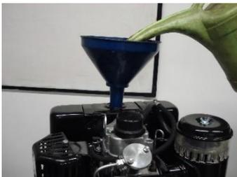
9. Yakıt deposunu süzölmüş ve dinlendirilmiş temiz Diesel yakıtı ile doldurun.
