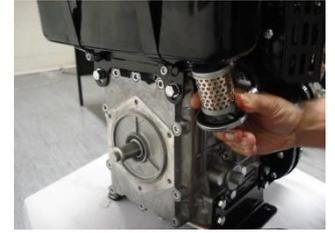
Yakıt filtre tablasını yuvasına yerleştirin ve tablayı depoya tespit eden civatayı sıkın. Reassemble filter cover and tighten fixing bolt. Rassembler le couvercle du filtre et serrer le boulon de fixation.
