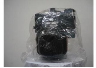
Motoru kuru bir yerde, bir altlık üzerinde naylonla örtülmüş olarak saklayın. Cover the engine with plastic bag and store in a dry place. Couvrir le moteur avec un sac en plastique et le garder dans un endroit sec.
