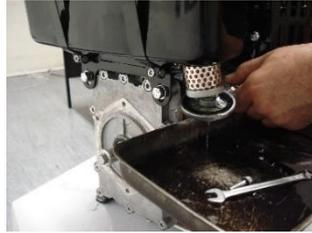
Yakıtın boşalmasını bekleyin, tespit civatasını tam sökün. Filtre tasını çıkartın. Filtre elemanını ayırın. Drain the fuel tank completely, then remove the bolt, cover and filter cartridge. Vider le réservoir complètement, après enlever le boulon, le couvercle et la cartouche.
