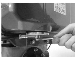
Yakıt deposunun altına uygun bir kap koyun ve filter tablası tespit civatasını gevşetin.
