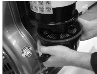
Havafiltresi temizliği: Mandalları açarak havafiltresi alt kabını çıkarın. Clean air filter: Loosen hooks and remove bowl. Nettoyer le filtre à air: ouvrir les crochets et enlever la cuve.
