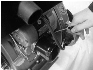
Motor yatay satılıktır duruyorken yağ seviyesini kontrol edin Check oil level with engine at horizontal position. Contrôler le niveau d'huile avec moteur en position horizontale.
