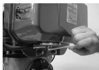
Yakıt filter tablasını yuvasına yerleştirin ve tablayı depoya tespit eden civatayı sıkın.
