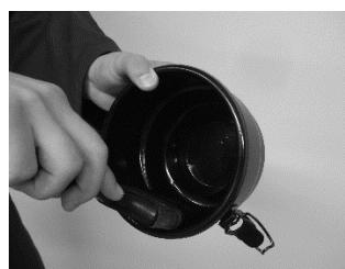
Filtre kabı içindeki kirli yağı boşaltın. Kabı gazyayı ile yıkayın. Empty dirty oil from bowl and clean wash with kerosene or gasoil. Vider l'huile de la cuve et la laver avec du pétrole ou du gazoil.
