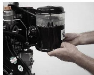
Havafiltresi üst parçasını motora takın.
