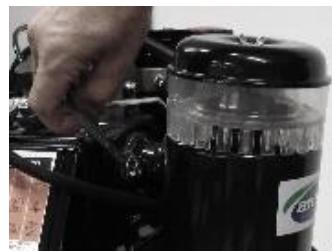
Havafiltresi üst parçasını motora bağlayan tespit somunlarını söküün.
