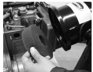
Üst parça ve sünger elemanı gazyağı ile temizleyin.
