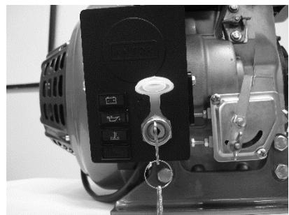
24. Elektrik marslı motorlarda kontak anahtarını saat ibrelerinin tersi yönde çevirerek kapalı duruma getirin.
