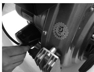
Motor çalışırken yağı seviye çubuğu çıkarmayın.
