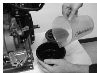
Kabı, seviye çizgisine kadar temiz motor yağı ile doldurun. Fill bowl with clean engine oil up to the marked level. Remplir la cuve jusqu'au niveau marqué avec de l'huile de moteur propre.
