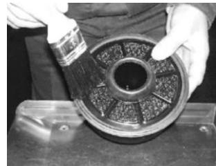
Mazot / gazyayı veya solvent ile temizleyin. Clean wash with kerosene /gasoil or solvent. Laver la masse filtrante avec du pétrole ou du gazoil.
