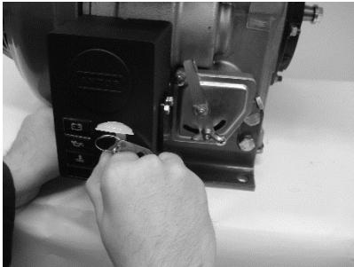
18. Kontak anahtarını sağa çevirip yarımkontak durumuna getirin. Sarj ikaz ve yağ basıncı ikaz lambaları yanacaktır.
