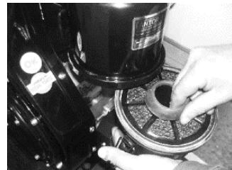
Havafiltresi elemanını çıkarın. Remove air filter element. Enlever la masse filtrante
