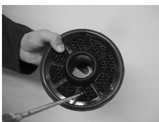
Basınçlı hava tutarak havafiltresi elemanını kurutun. Dry air filter element with compressed air. Sécher la masse filtrante avec l'air comprimé.
